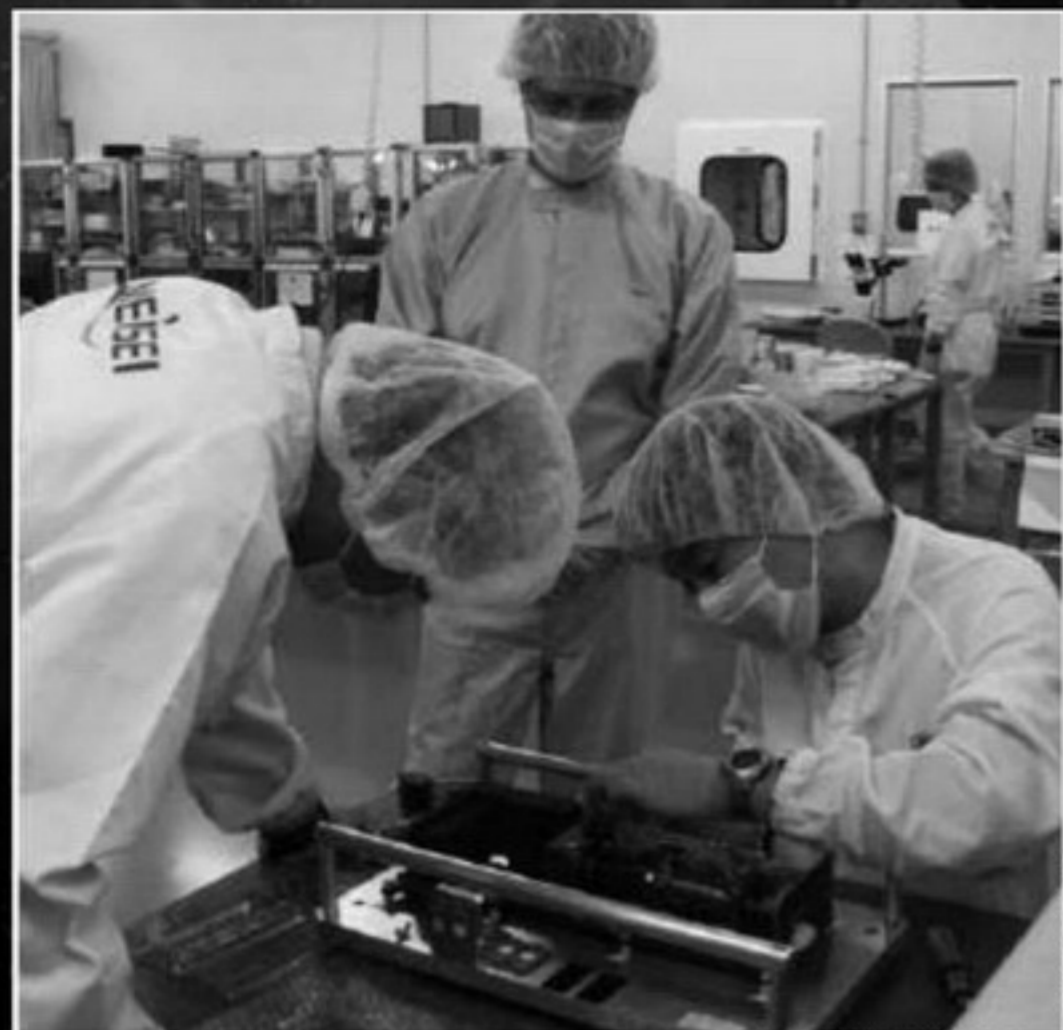
Входной контроль сканирующего узла российско-японской камеры MSASI
