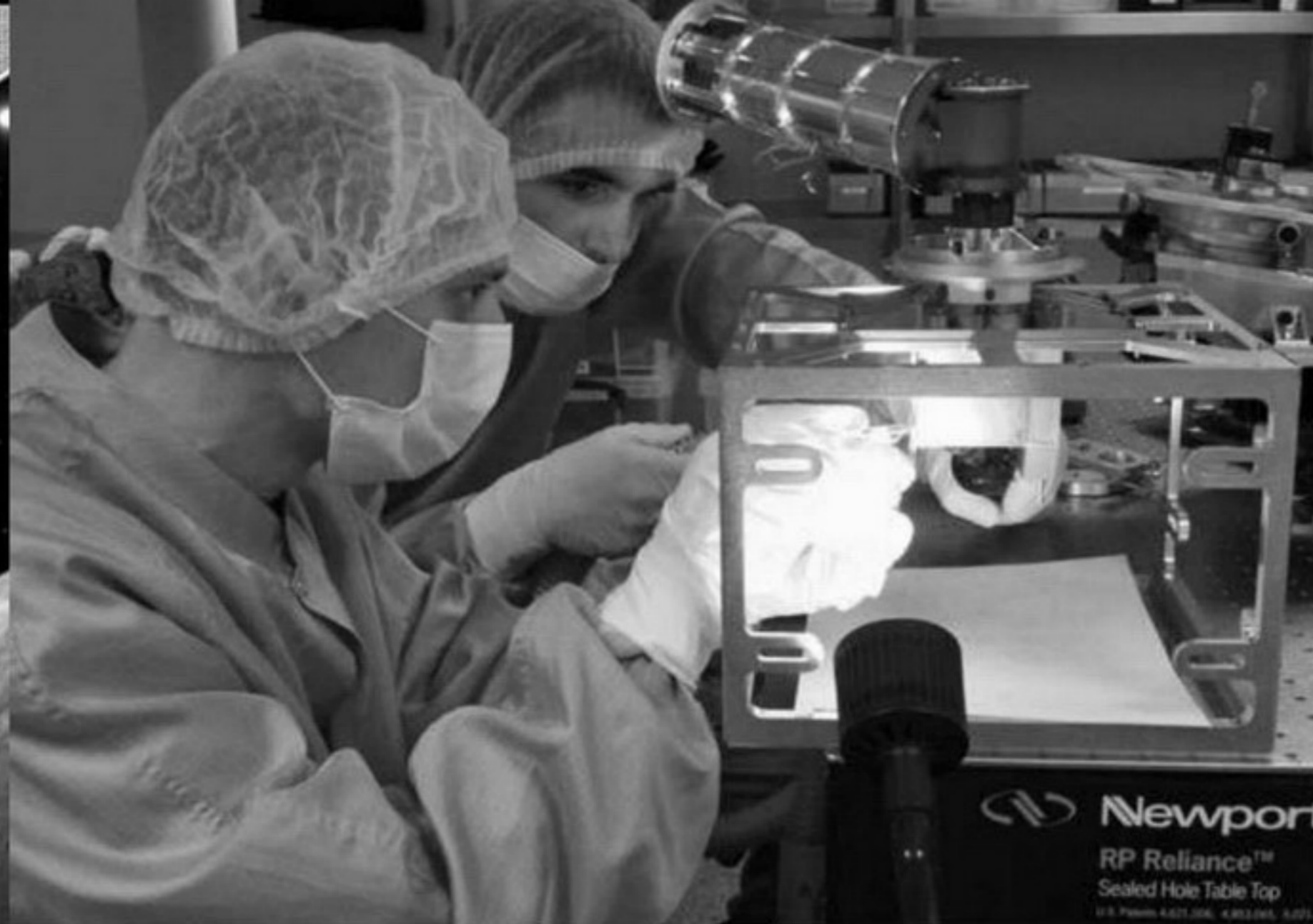
Настройка поворотного узла спектрометра ФЕБУС в ИКИРАН
