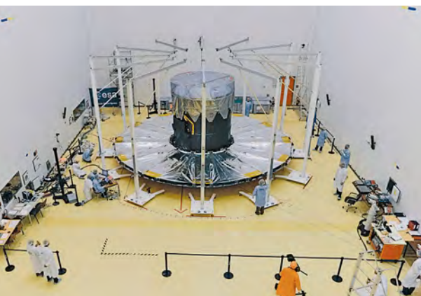
Рис. 2. «Гайя» на завершающем этапе сборки. Gaia Deployable Sunshield Assembly (DSA) во время тестирования развешивания в интеграционном здании S1B на европейском космодроме Куру, Французская Гвиана, 10 октября 2013 года. http://www.esa.int/ESA_Multimedia/Images/2013/10/Deployment_of_Gaia_s_DSA19 Права принадлежат ESA–M. Pedoussaut, 2013
