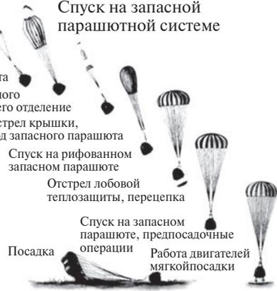
Схемы работы основной и запасной парашютных систем корабля «Союз». Во врезке: при спуске «Союза-1» не раскрылся основной парашют. Рисунок и фото РКК «Энергия» им. С.П. Королёва
