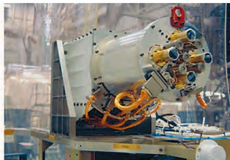
Научные приборы, установленные на космической обсерватории "Дискавер": фотокамера EPIC и радиометр NISTAR. Фото NASA
