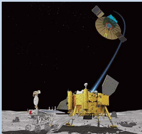
Китайские луноход и посадочный аппарат миссии “Чанъэ-4” передают информацию с Луны на Землю через спутник-ретранслятор “Цюэцзяо”. Рисунок CNSA.
