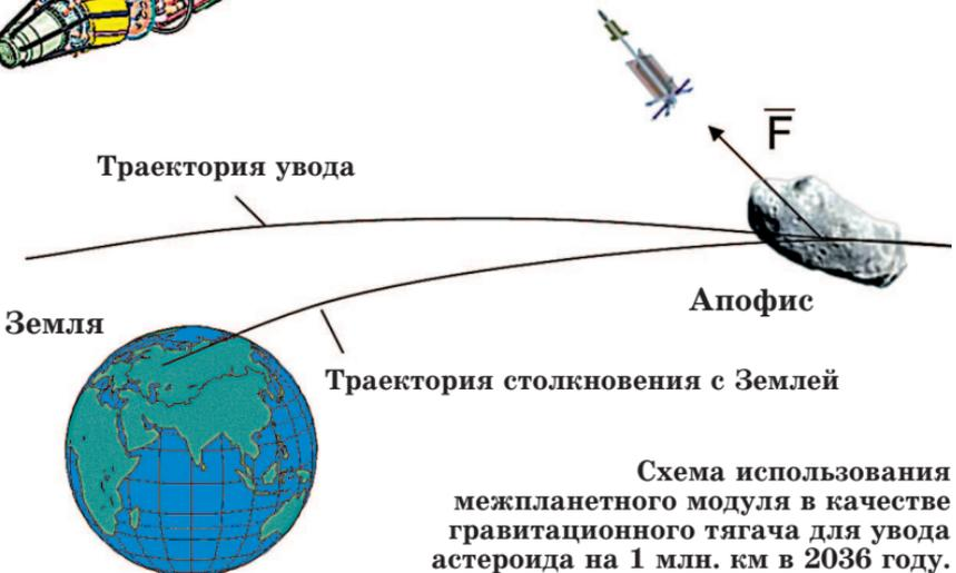
Схема использования межпланетного модуля в качестве гравитационного тягача для увода астероида на 1 млн. км в 2036 году.
