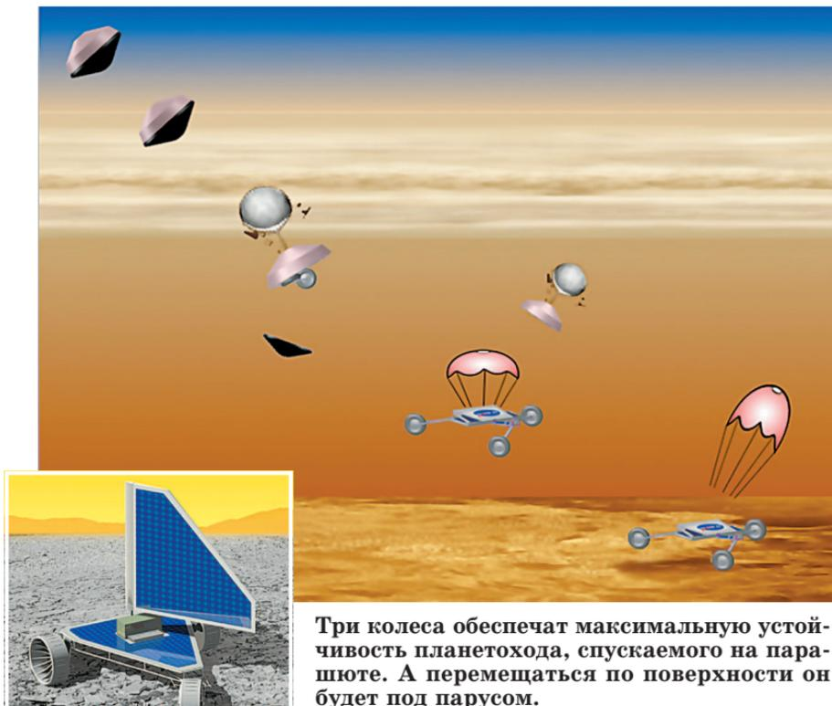
Три колеса обеспечат максимальную устойчивость планетохода, спускаемого на парашюте. А перемещаться по поверхности он будет под парусом.
