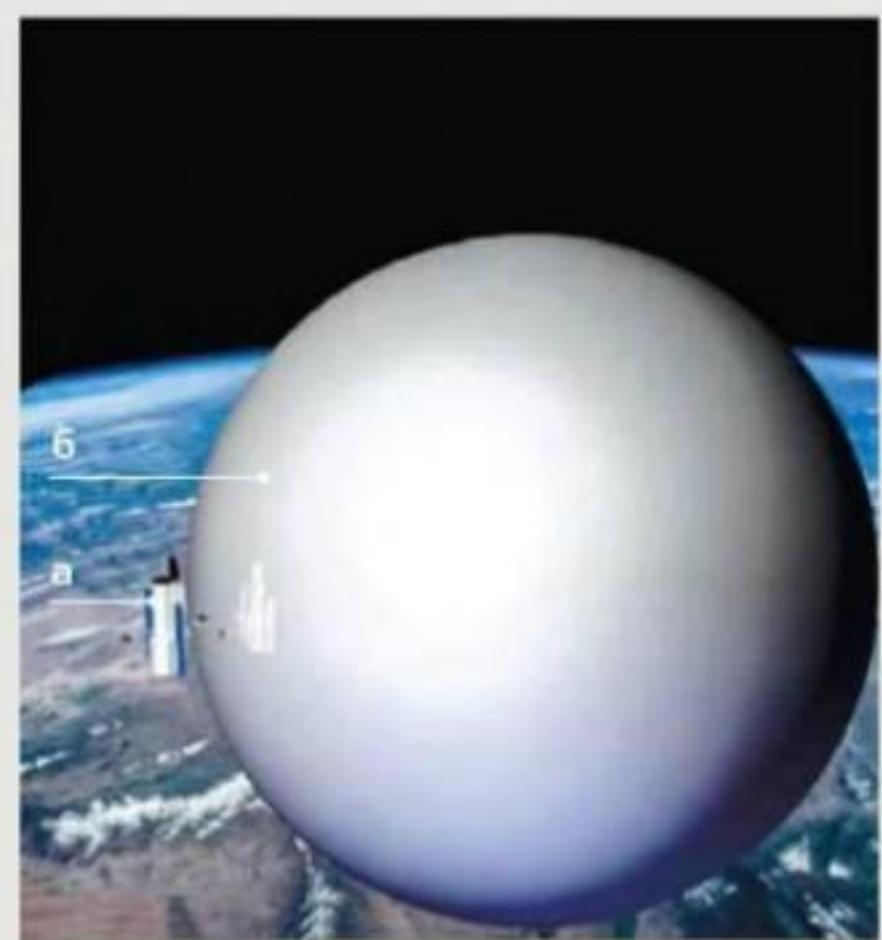
**Рис. 11. Аэродинамическое устройство увода космического аппарата с рабочей орбиты по технологии Gossamer Orbit Lowering Device:**
