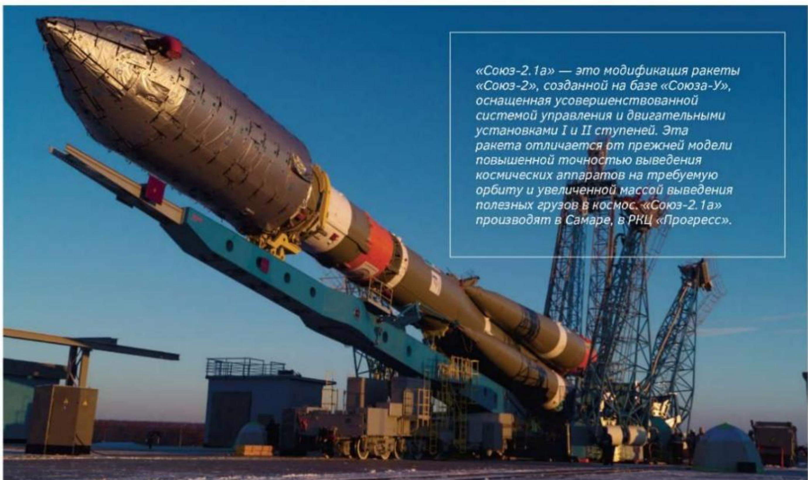
«Союз-2.1а» — это модификация ракеты «Союз-2», созданной на базе «Союза-У», оснащенная усовершенствованной системой управления и двигательными установками I и II ступеней. Эта ракета отличается от прежней модели повышенной точностью выведения космических аппаратов на требуемую орбиту и увеличенной массой выводения полезных грузов в космос. «Союз-2.1а» производят в Самаре, в РКЦ «Прогресс».
