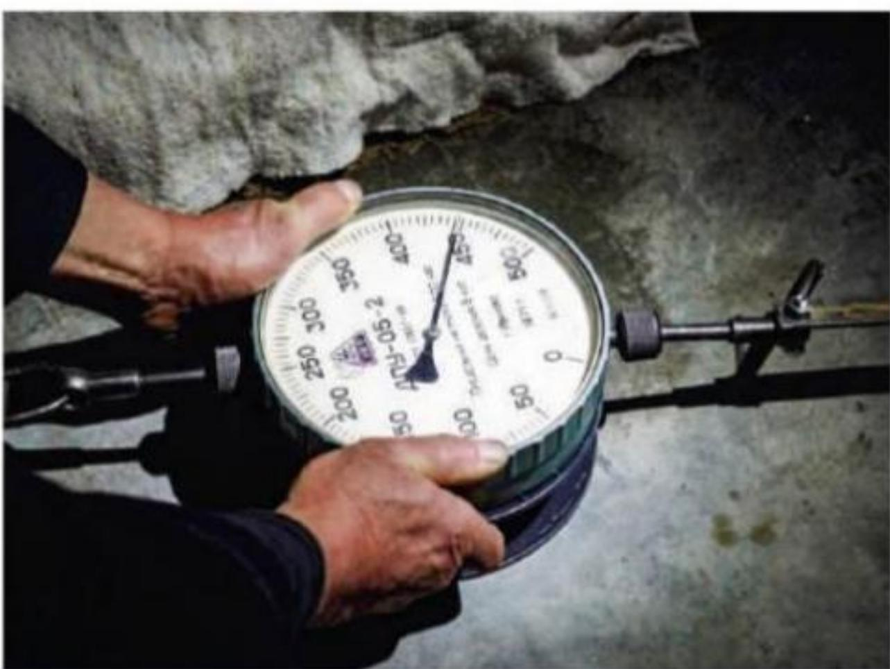
**Рис. 8.** Фото фиксации величины импульса силы  $F_t$  тяги в 450 кгс, создаваемого КвД-1-2009
