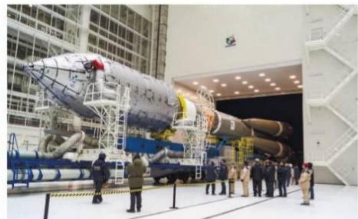
Вывоз ракеты из МИК РН на стартовый комплекс. Ракета-носитель с космической головной частью на стартовый комплекс доставляется по железной дороге специальным составом из тепловоза, агрегата терmostатирования, агрегата прикрытия и транспортно-установочного агрегата.
