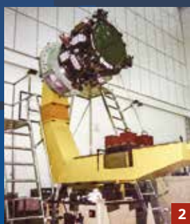
4. КА EXPRESS на взвешивании, центровке и балансировке в фирме IABG (Германия). Юрий Корнилов – справа
