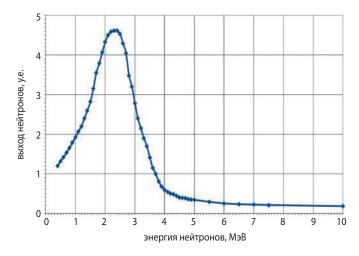
рисунок 1. Спектр нейтронов от изотопа плутоний-238
