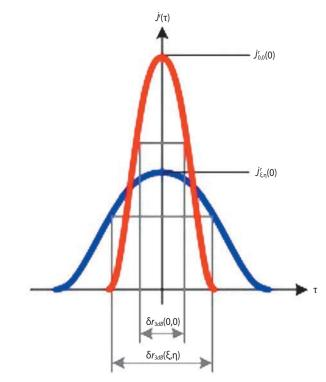
**рисунок 4.** Получение величины, обратной относительной ширине главного лепестка одномерной функции отклика по уровню минус 3 дБ
