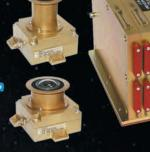
система технического зрения СТС-Л предназначена для проведения ТВ-съёмки, стереосъёмки
