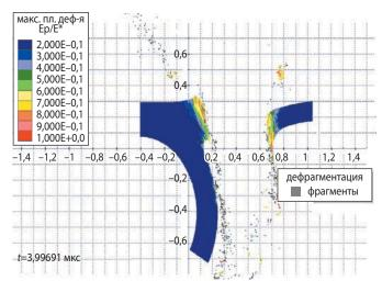
**рисунок 18**. Состояние пары «ударник — преграда» в опыте № 7
