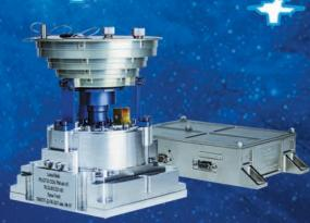
прибор Пилот-Д – прототип телевизионной подсистемы служебной аппаратуры для высокоточной околопланетной навигации и уклонения от опасностей при посадке
