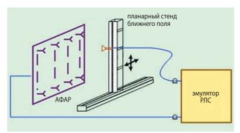
рисунок 2. Стенд ближнего поля
