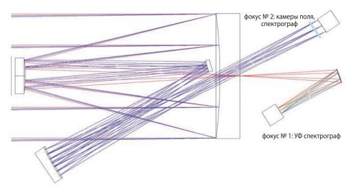
рисунок 5. Концептуальный вид многоцелевого телескопа с апертурой 60 см с двумя фокусами
