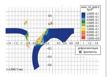
**рисунок 15.** Состояние пары «ударник – преграда» в опыте № 4
