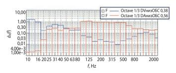
**рисунок 7.** Вибрационное нагружение основной панели БС
