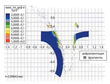
**рисунок 17.** Состояние пары «ударник – преграда» в опыте  $\mathfrak{N}_{2}$  6
