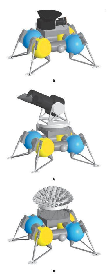
**рисунок 2.** Общий вид посадочного аппарата с телескопами: 15-30 см (**a**), 60 см (**б**) и мультиапертурным (**B**)
