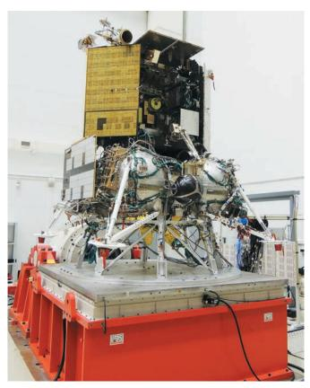
**рисунок 2.** КА «ЛУНА-ГЛОБ» на вибростенде
