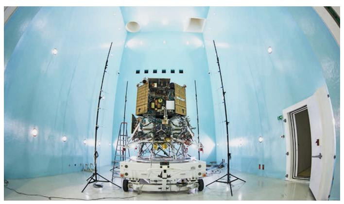
**рисунок 3.** КА «ЛУНА-ГЛОБ» в акустической камере
