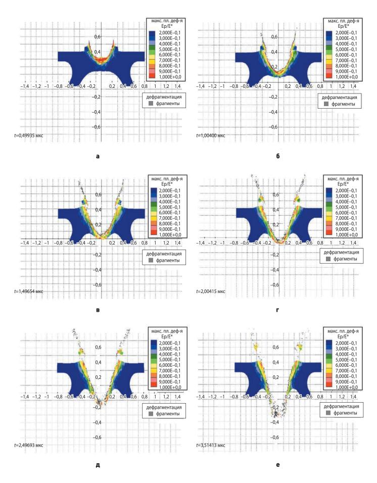
**рисунок 12.** Состояние пары «ударник — преграда» в опыте  $N_2$  1 в градации по степени повреждения материала в различные моменты времени t:
