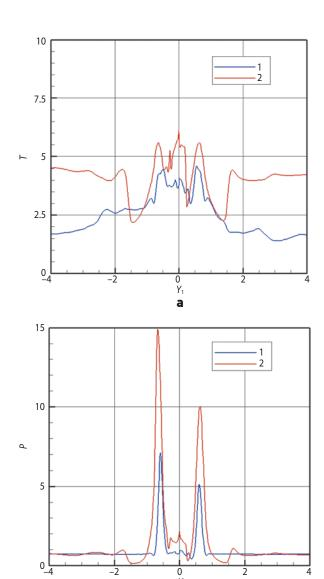
**рисунок 3.** Профили температуры T (**a**) и давления P (**б**) вблизи посадочной поверхности для двух режимов ТДУ:  $\mathbf{1} - G = G_{\min}$ ;  $\mathbf{2} - G = G_{\max}$
