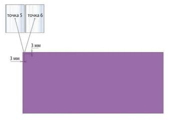
**рисунок 3.** Взаимное расположение сборки ТБ и ИМС в БВМ с указанием расстояния от ИМС до каждого из ТБ. Представлен «худший» случай расположения ИМС в приборе — максимальное приближение к сборке ТБ. Расстояние от ИМС до: TБ1-87,7 мм, TБ2-77,5 мм, TБ3-87,7 мм, TБ4-88,4 мм, TБ5-78,3 мм, TБ6-88,4 мм
