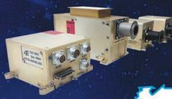
прибор ЛИС-ТВ-РПМ инфракрасный спектрометр для дистанционного исследования минералогического состава поверхности Луны
