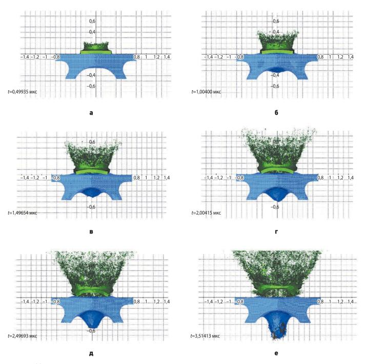
**рисунок 11.** Состояние пары «ударник – преграда» в опыте № 1 в различные моменты времени t: **a** -0.5 мкс; **6** -1.0 мкс; **B** -1.5 мкс; **г** -2.0 мкс; **д** -2.5 мкс; **e** -3.5 мкс
