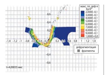
**рисунок 13.** Состояние пары «ударник – преграда» в опыте № 2
