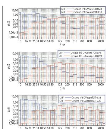
**рисунок 5.** Вибрационное нагружение ТСП приборного контейнера
