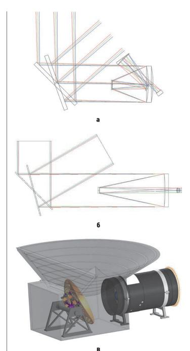
**рисунок 3.** Концептуальный вид телескопа с апертурой 15–30 см с системой наведения с помощью плоского зеркала: оптическая схема УФ ИК-телескопа (**a**), оптическая схема телескопа для УФ-наблюдений (**б**), компоновка телескопа с зеркалом и блендой (**B**)
