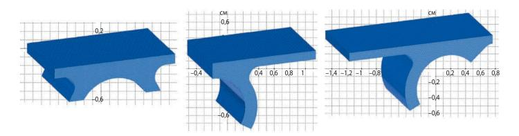
рисунок 3. Варианты модельных конфигураций ТТ профиля № 200095
