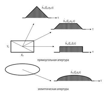
**рисунок 3.** Импульсные характеристики АФАР в зависимости от её геометрии
