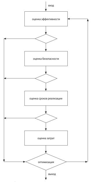
**рисунок 7.** Алгоритм решения задачи оптимизации надёжности подсистем КА при наличии требований безопасности
