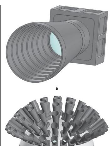
**рисунок 6.** Схематический вид одиночного линзового УФ-объектива (**a**) и мультиапертурного телескопа (**б**) в случае расположения объективов на едином основании
