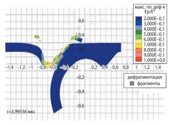
**рисунок 16.** Состояние пары «ударник – преграда» в опыте № 5
