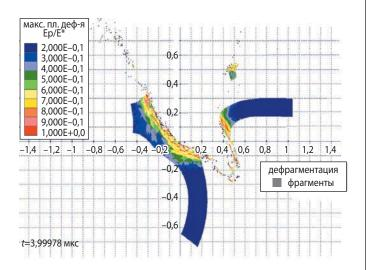
**рисунок 14.** Состояние пары «ударник – преграда» в опыте № 3
