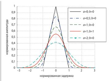
**рисунок 5.** Деградация одномерной функции отклика по дальности при отклонении луча
