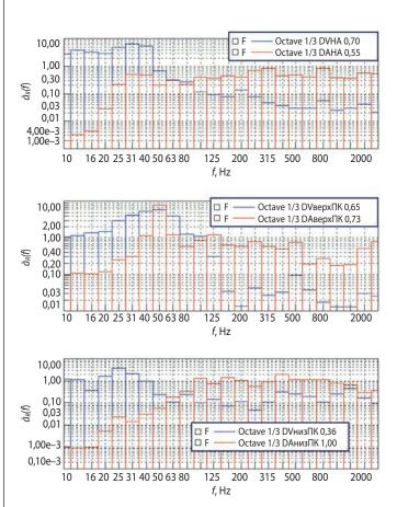
**рисунок 6.** Вибрационное нагружение оборудования на ПК
