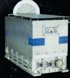
прибор ЛАЗМА-ЛР масс-спектрометр для прямого исследования образцов реголита
