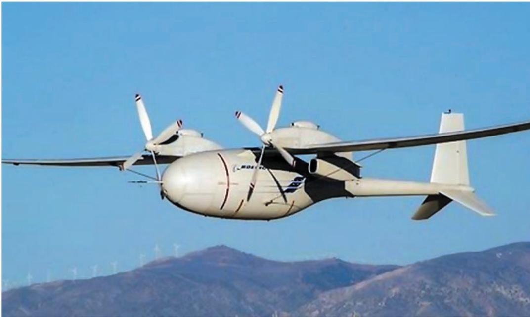
**рисунок 3.** ПКА типа «Phantom Eye»
