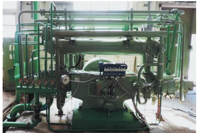
рисунк 1. Общий вид компрессора 2ВМ4-8/401 на  $P_{\text{изб}}=35$  МПа
