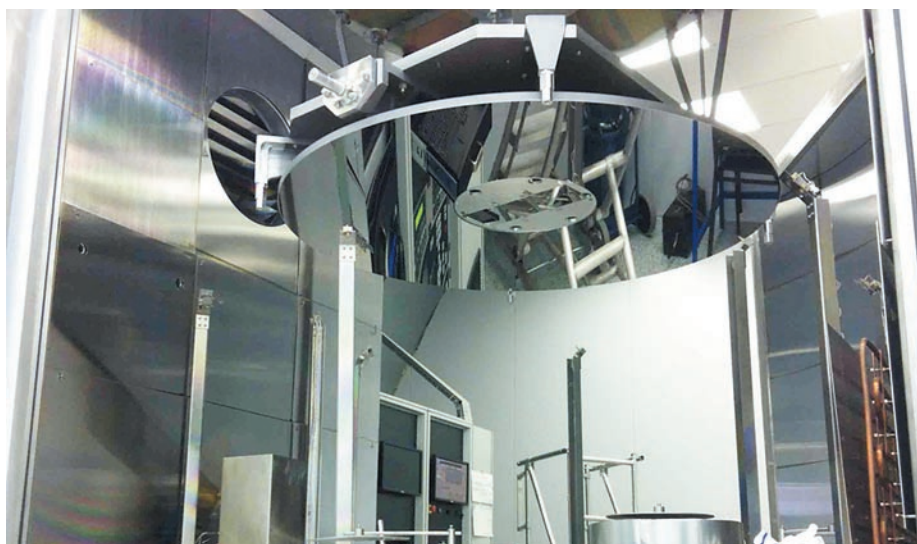
рисунк 7. Макетный образец главного зеркала телескопа Т-170М с закрепленными в центре образцами-свидетелями после процесса нанесения
