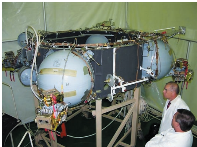
рисунки 6. Сборка служебного модуля «НАВИГАТОР» в НПО им. С.А. Лавочкина
