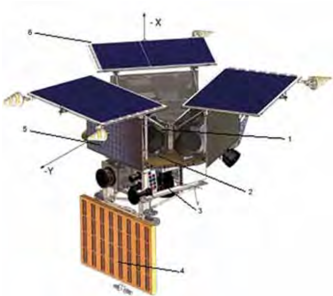
1 – каркас; 2 – платформа служебных систем; 3 – платформа научной аппаратуры; 4 – «Зонд-ПП»; 5 – радиатор-излучатель; 6 – батарея фотопреобразователей. рисунок 1. Общий вид КА
