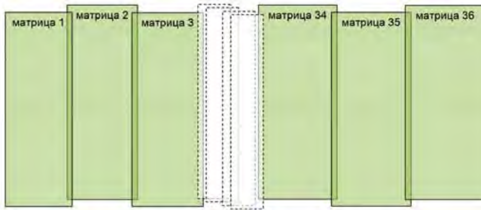
рисунок 2. Схема расположения на местности изображений, сформированных светочувствительными матрицами
