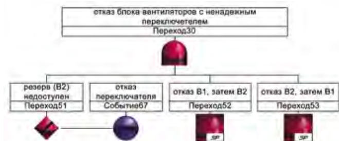
рисунк 5. Динамическое дерево отказов канала управления вентиляторами ГЖА НПО
