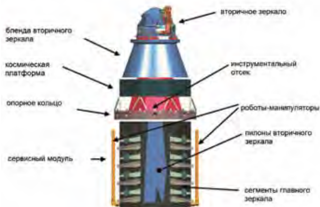
рисунок 3. Компоновка телескопа в разобранном виде под обтекателем
