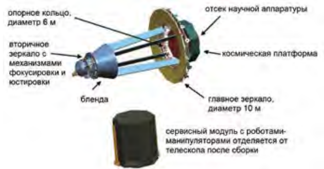
рисунк 2. Концепция построения 10-метрового космического телескопа компании Ball Aerospace
