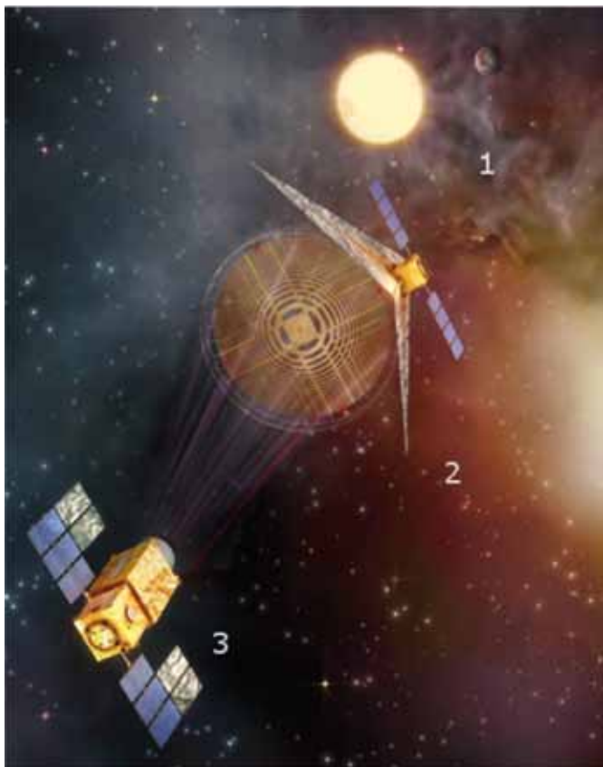
1 – источник (звезда + планета); 2 – пластина Френеля, установленная на автономной платформе; 3 – фокальный узел, также установлен на платформе. рисунок 1. Дифракционный телескоп Френеля
