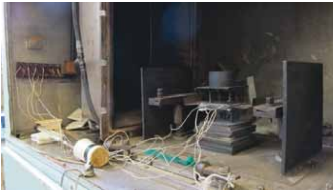
рисунк 4. Установка для измерения теплопроводности методом стационарного плоского слоя
