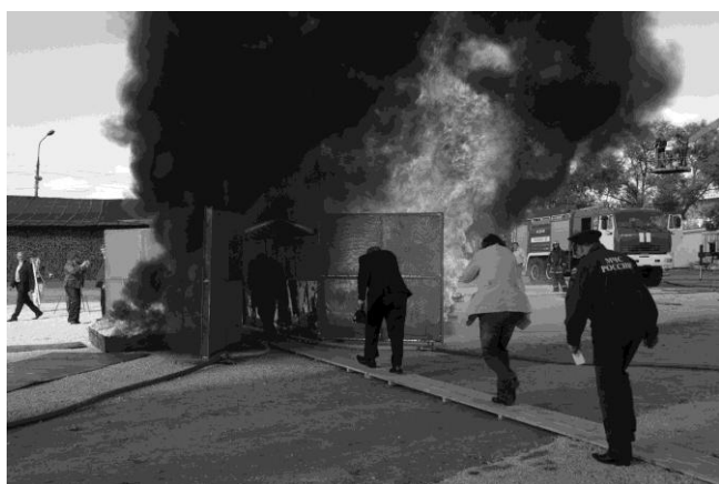
Рисунок 4. Проход посетителей выставки через палатку, боковые стенки которой защищены от пламени гелем «Firelce»
