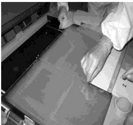
Рисунок 1. Монтаж блоков аэрогеля (200x200x50 мм), изготовленных в Институте катализа им. Г.К. Борескова СО РАН, в Детектор Большого Андронного Коллайдера (ЦЕРН. Женева. Швейцария)
