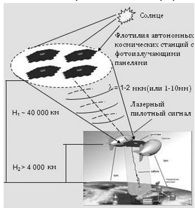
Рисунок 1. Схема космической солнечной электростанции и автономных спутников
