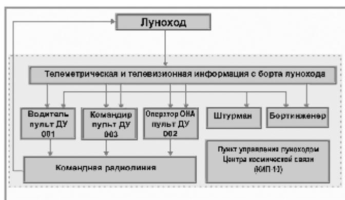
**Рисунок 3. Структурная схема телеоператорного управления луноходом**
