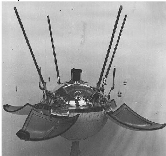
**Рисунок 5. Посадочный модуль КА «Луна-9»**
