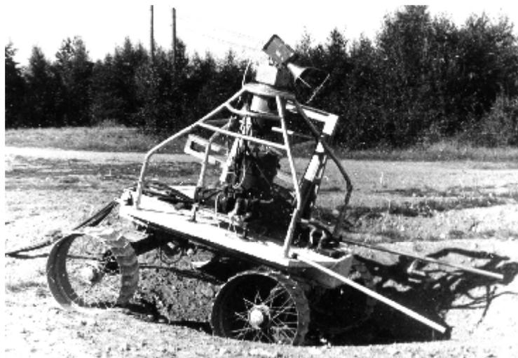
Рисунок 1. Экспериментальный образец шасси с системой дистанционного управления (СДУ)
