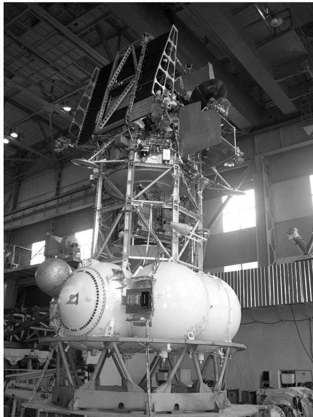
**Космический комплекс "Фобос-Грунт" на вибро-динамических испытаниях**
