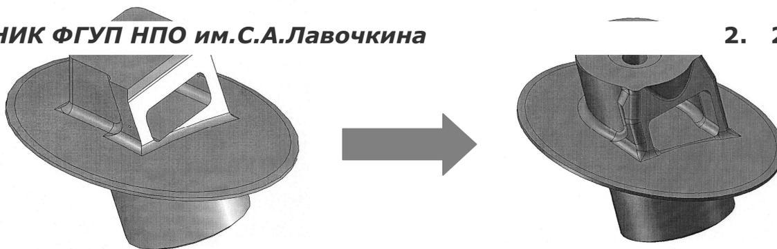
Рис. 5. Изменение конструкции верхней силовой опоры
