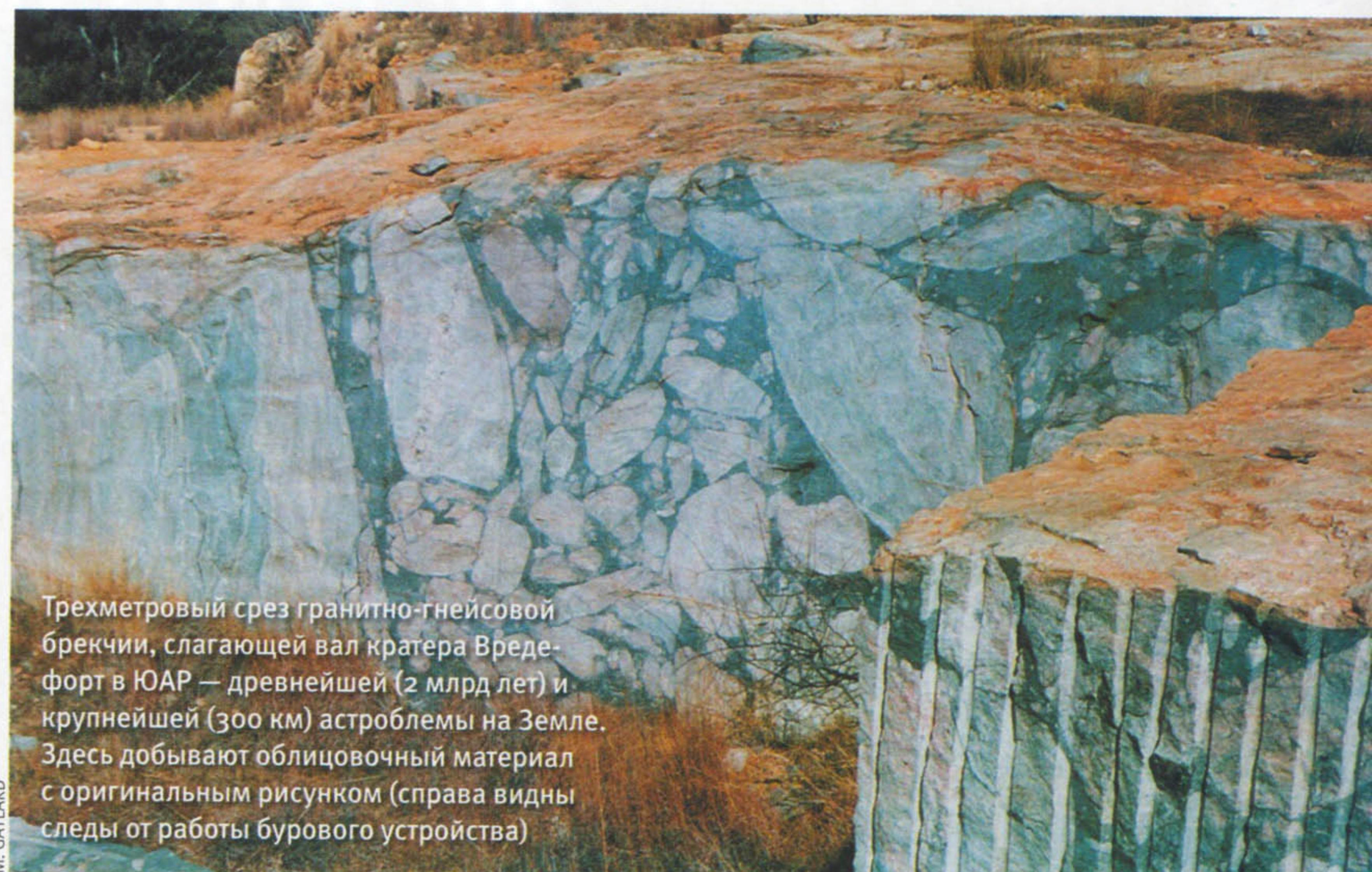
Трехметровый срез гранитно-гнейсовой брекции, слагающей вал кратера Вредефорт в ЮАР — древнейшей (2 млрд лет) и крупнейшей (300 км) астроблемы на Земле. Здесь добывают облицовочный материал с оригинальным рисунком (справа видны следы от работы бурового устройства)
