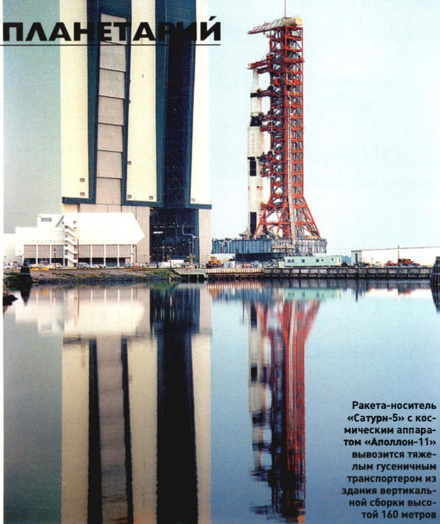
**Ракета-носитель «Сатурн-5» с космическим аппаратом «Аполлон-11» вывозится тяжелым гусеничным транспортером из здания вертикальной сборки высотой 160 метров**
