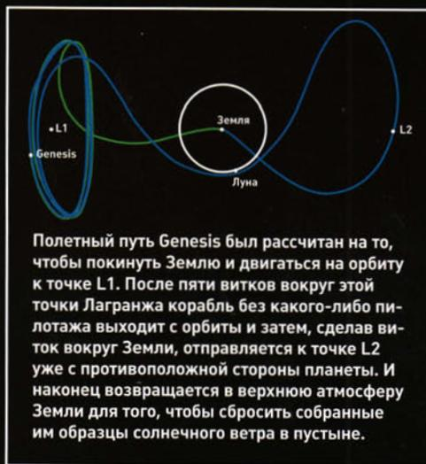
Полетный путь Genesis был рассчитан на то, чтобы покинуть Землю и двигаться на орбиту к точке L1. После пяти витков вокруг этой точки Лагранжа корабль без какого-либо пилотажа выходит с орбиты и затем, сделав виток вокруг Земли, отправляется к точке L2 уже с противоположной стороны планеты. И наконец возвращается в верхнюю атмосферу Земли для того, чтобы сбросить собранные им образцы солнечного ветра в пустыне.
