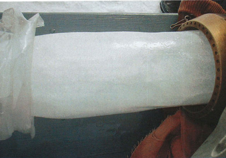
▲ ▼ Ледяные керны извлекались с глубин от 750 до 1000 метров
