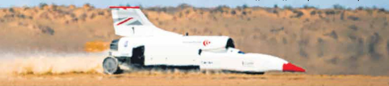
при скорости свыше полутора тыс. километров в час и частоте вращения колёс свыше 10,5 тыс. оборотов. Но одновременно с высочайшей их прочностью нельзя забывать и о весе колёс, которые должны быть максимально легкими. Гонимый болид Bloodhound SSC представляет собой конструкцию из пяти различных типов углеродного волокна, на создание которой понадобилось более 10 тыс. часов. Для обеспечения максимальной прочности реактивного автомобиля слои
