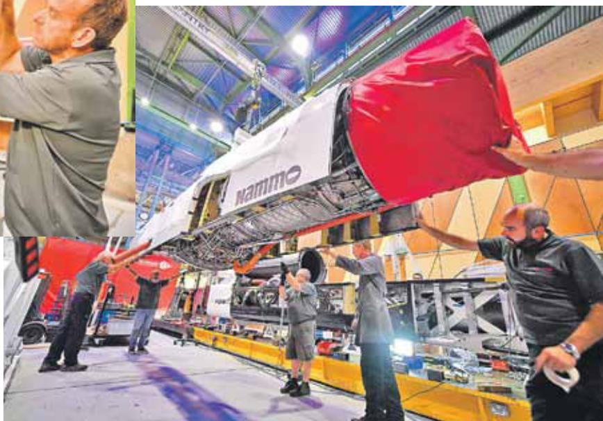
вмонтирована система торможения с помощью парашюта, подняты амортизаторы, появились дополнительные датчики давления воздуха и нагрузки, а также интегрирована система обнаружения и тушения пожара.
