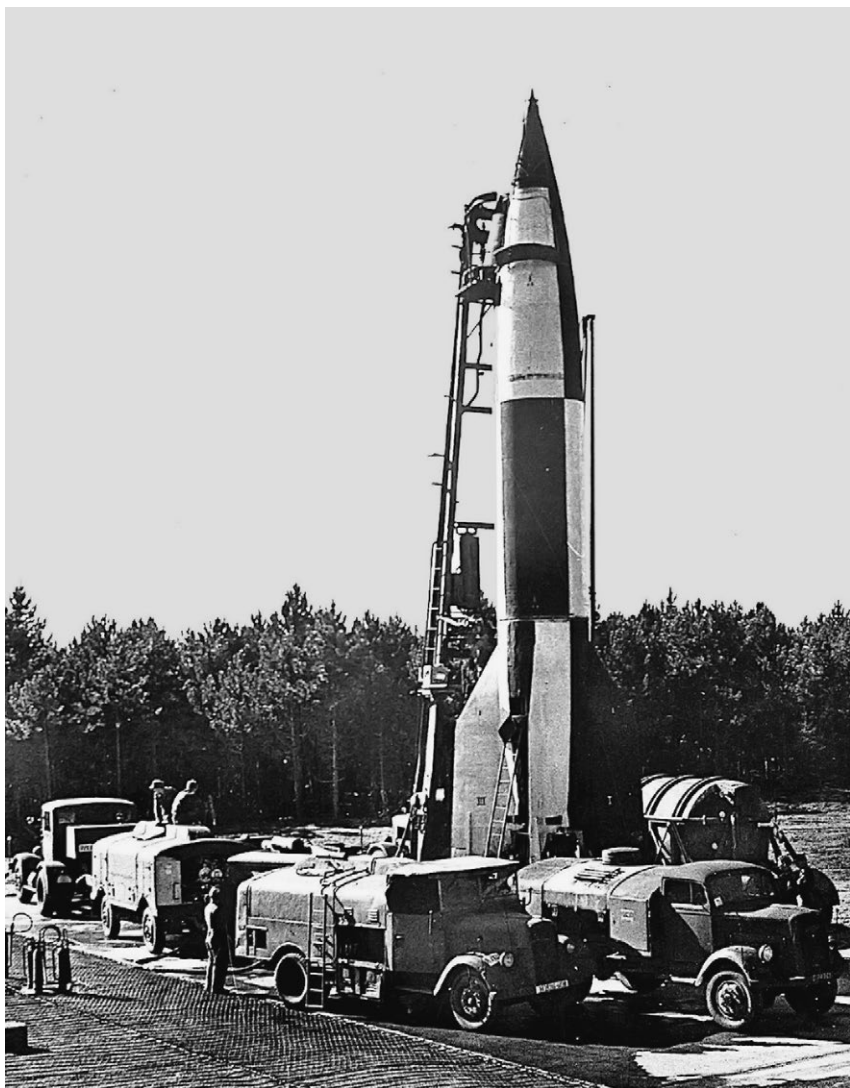
Заправка ракеты A4 топливом и кислородом (1944)
