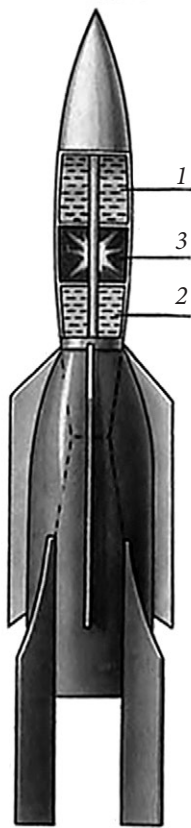
Сначала Оберт спроектировал для рекламы кинофильма двухступенчатую ракету 1 — баки для горючего (бензин); 2 — баки для окислителя (жидкий кислород); 3 — камера сгорания
