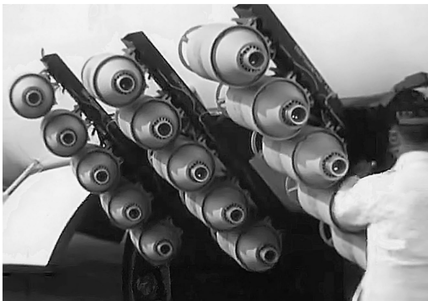
Первый серийный ракетный ускоритель взлета (Jet-Assisted Take Off — JATO)
