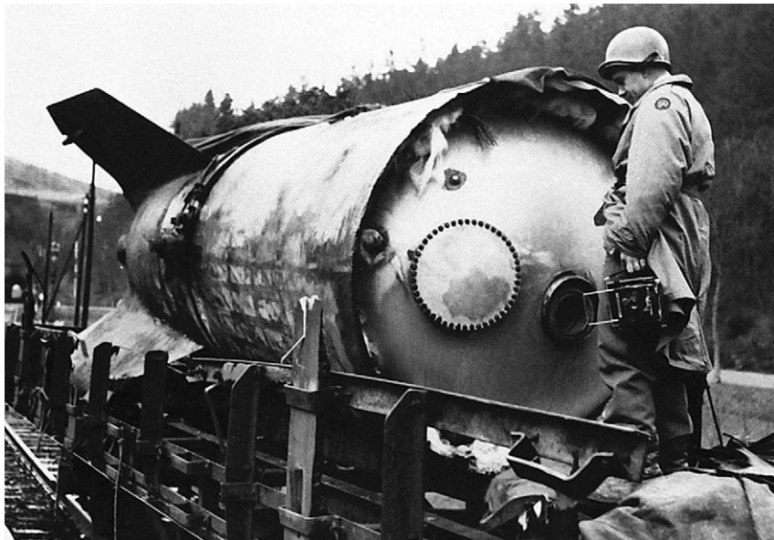
Кислородный бак, за ним — хвостовой отсек
