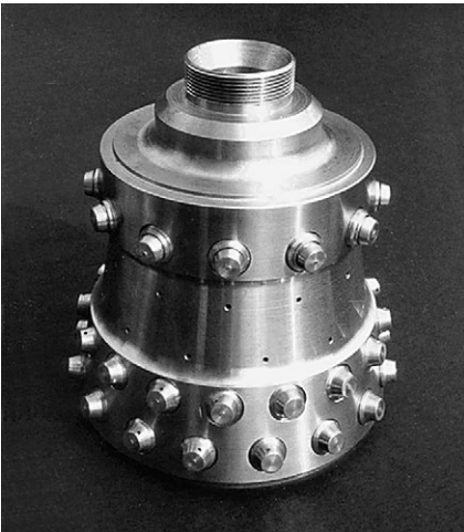
Один из 18 блоков форсунок, распыляющих топливо
