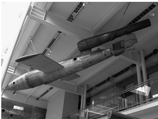
Fi-103 в музее (отсек БЧ сделан из древесины, корпус — из листовой стали)
