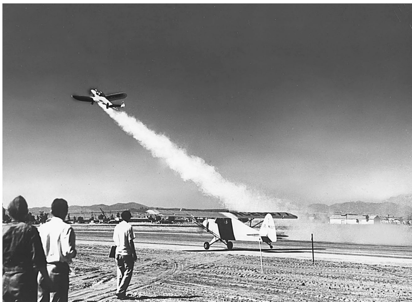
Взлет самолета «Engourer» 12 августа 1941 г. с ускорителями JATO
