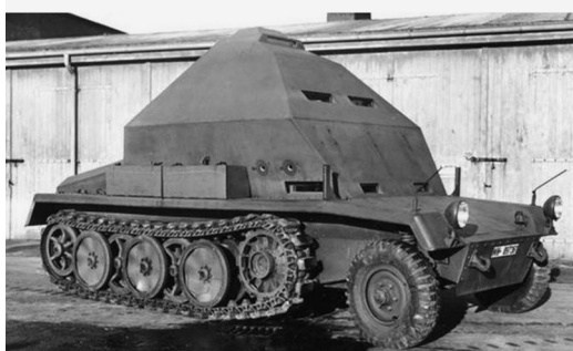
Бронированный самоходный пульт управления пусками ракет (Feuerleitpanzer)
