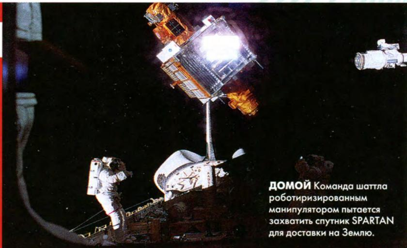
**ДОМОЙ** Команда шаттла роботизированным манипулятором пытается захватить спутник SPARTAN для доставки на Землю.
