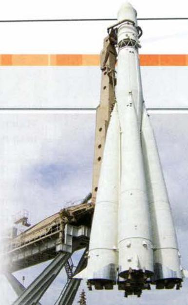
компонентов топлива. Они были выполнены по открытой схеме и имели 6 камер сгорания. Две из них использовались как рулевые.
