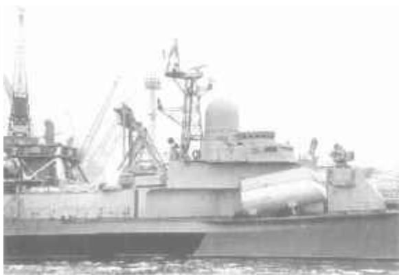
ПКР «Термит» в версии П-20 на МРК пр. 1234, построенном для Индии
