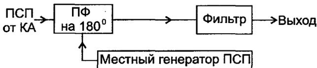
**Рис. 8. Выделение немодулированного несущего сигнала**
