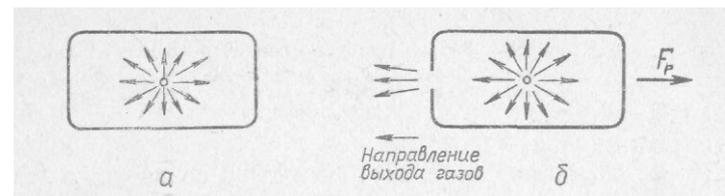
Рис. 27. Горение пороха в сосудах: а — закрытом; б — открытом.
