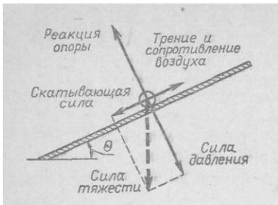
Рис. 2. Силы, действующие на шарик, скатывающийся по наклонной плоскости:
