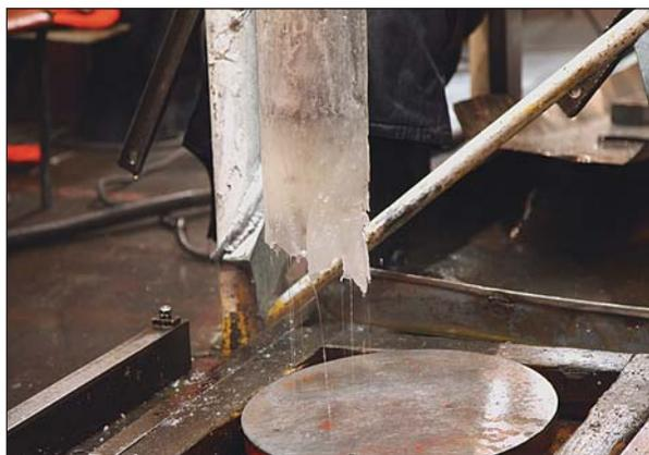
5 февраля 2012 г. в 20:25 по московскому времени вода подледникового озера Восток начала быстро поступать в скважину. Через 4 с после срабатывания датчиков лебедка заработала на подъем, и спустя 2.5 ч на поверхность был извлечен буровой снаряд, к которому «приклеилась» реликтовая вода оз.Восток.
