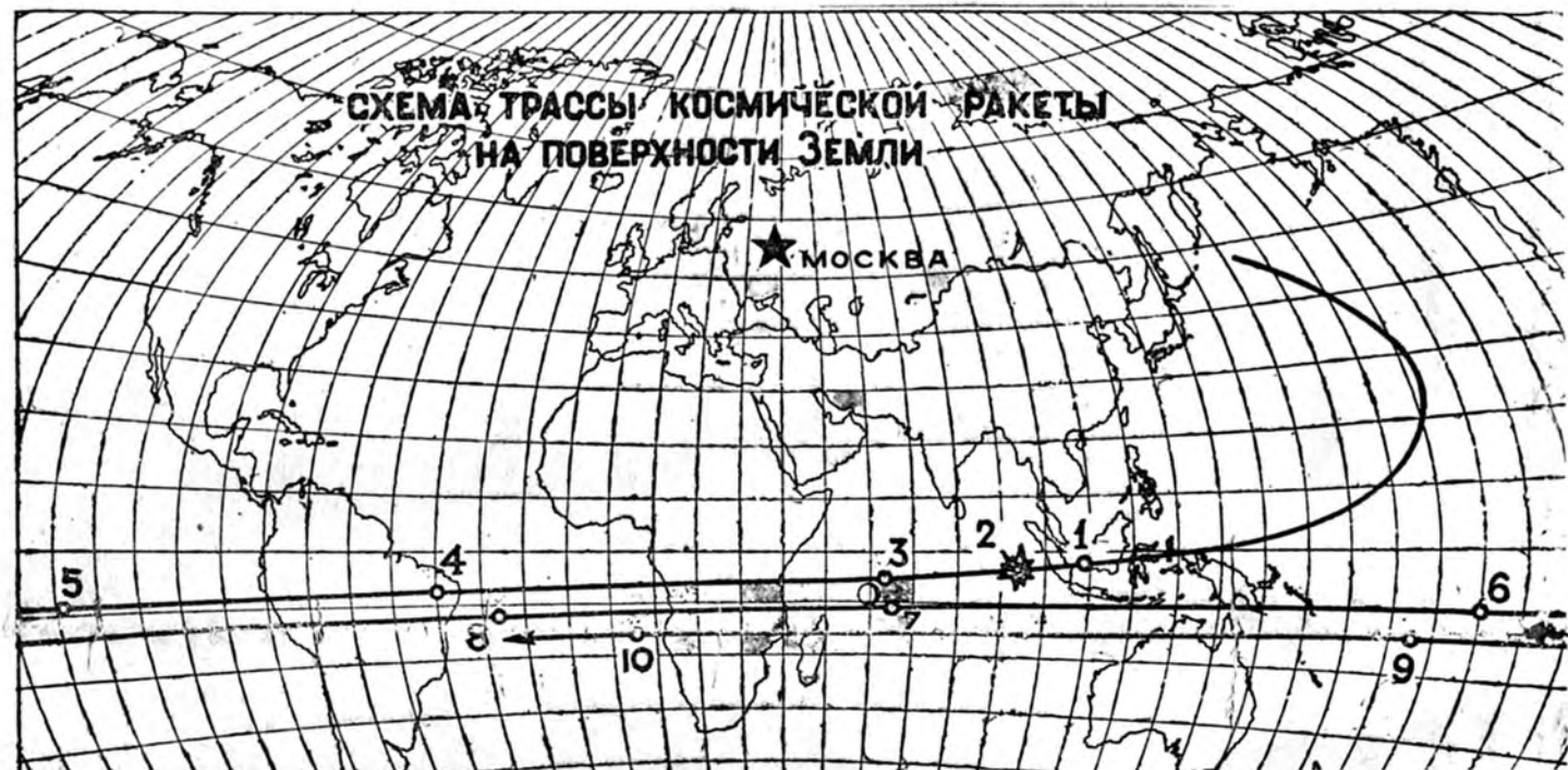
Цифры на схеме соответствуют последовательным положениям проекции ракеты на поверхность Земли. 1 — 3 часа 3 января, 100 тысяч километров от Земли; 2 — образование искусственной кометы; 3 — 6 часов, 137 тысяч километров; 4 — 13 часов, 209 тысяч километров; 5 — 19 часов, 265 тысяч километров; 6 — 21 час, 284 тысячи километров; 7 — 5 часов 59 минут 4 января, 370 тысяч километров — момент наибольшего сближения с Луной; 8 — 12 часов, 422 тысячи километров; 9 — 22 часа, 510 тысяч километров; 10 — 10 часов 5 января, 597 тысяч километров.
