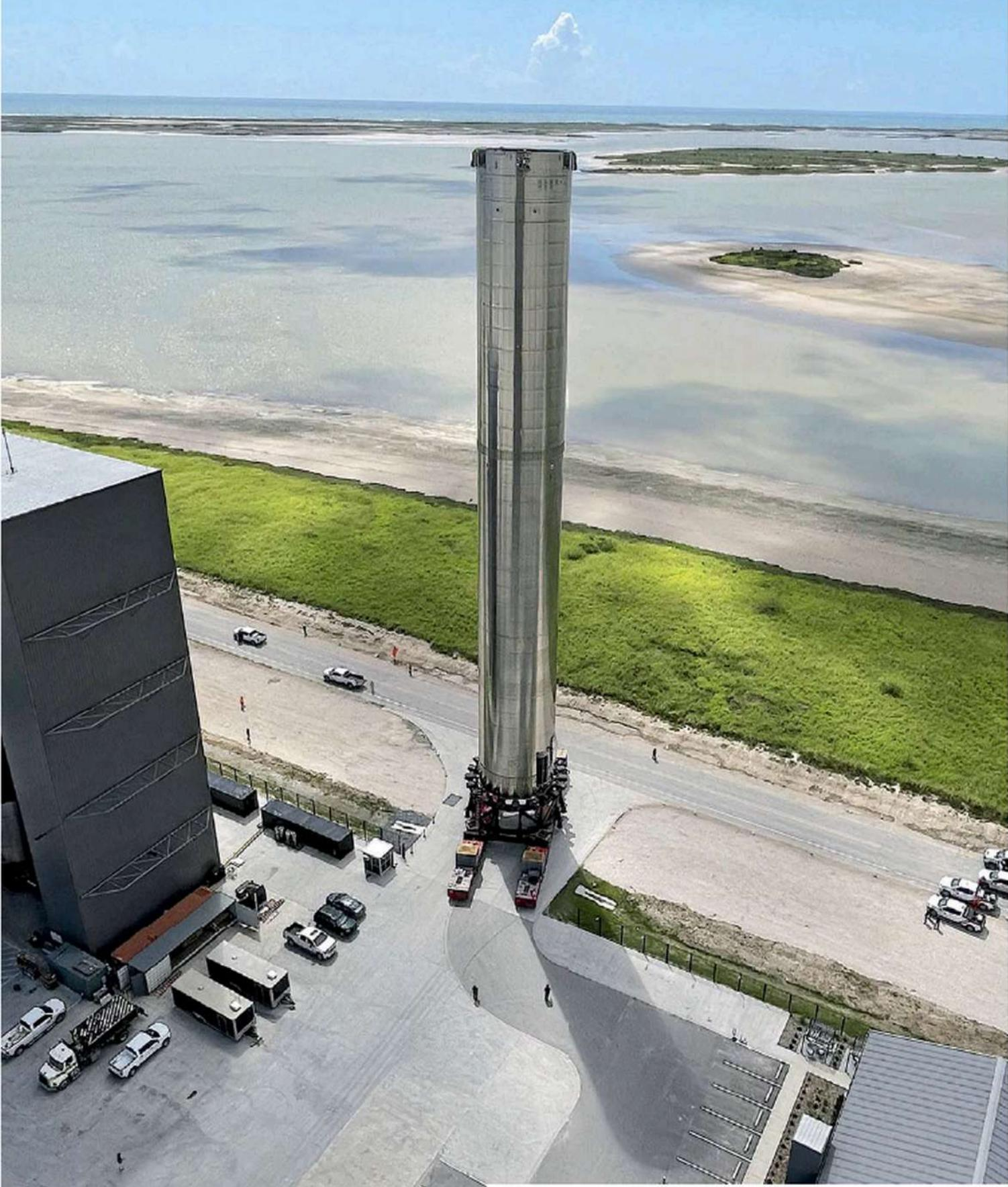
ДЛЯ ТРАНСПОРТИРОВКИ МАССИВНОЙ ПЕРВОЙ СТУПЕНИ НА СТАРТОВУЮ ПЛОЩАДКУ SPACEX ИСПОЛЬЗУЕТ КОЛЕСНЫЕ ПЛАТФОРМЫ ПРОИЗВОДСТВА TII GROUP. ДЕЙСТВУЯ В ПАРЕ, ОНИ СПОСОБНЫ ПЕРЕВОЗИТЬ БОЛЕЕ 1000 Т.
