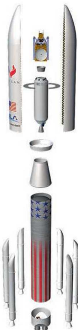
**VULCAN БУДЕТ ИМЕТЬ ДВЕ КОНФИГУРАЦИИ** обтекателя полезной нагрузки: диаметром 4 м с четырьмя твердотопливными ракетными ускорителями и диаметром 5 м – с шестью ускорителями (на рисунке).
