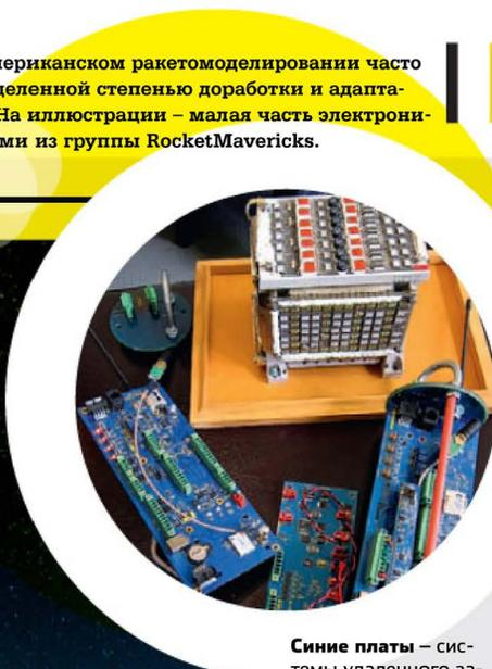
Синие платы – системы удаленного запуска и управления. Белый параллелепипед – один из блоков управления настоящего “Аполлона”.
