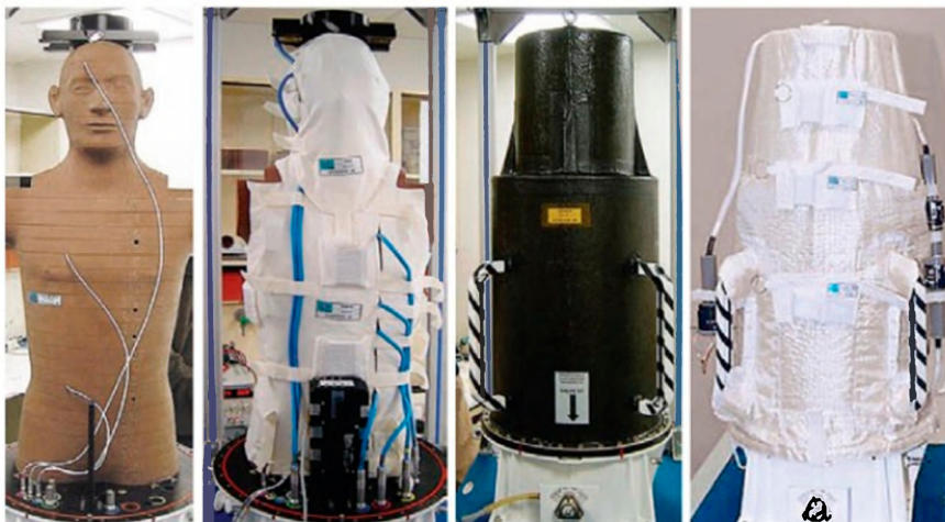
СЛОЕННЫЙ ДУБЛЕР Манекен Матрешка разрезан на 35 слоев (видны на левом снимке), в каждый из которых встроены различные датчики. Справа: Матрешка в различных “нарядах” (чехлах)
