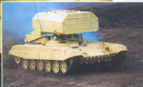
В отличие от ТОС установка ТОС-1 "Буратино" имеет увеличенный боекомплект – 30 ракет вместо 24
