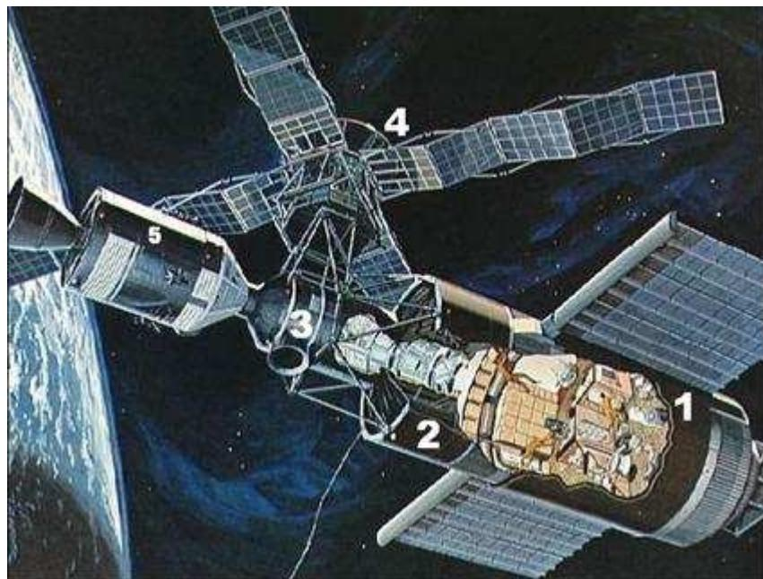
*Илл.1. Разрез станции «Скайлэб» .*
