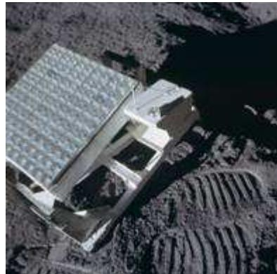
*Илл.9. Лазерный отражатель – набор призм специальной формы*
