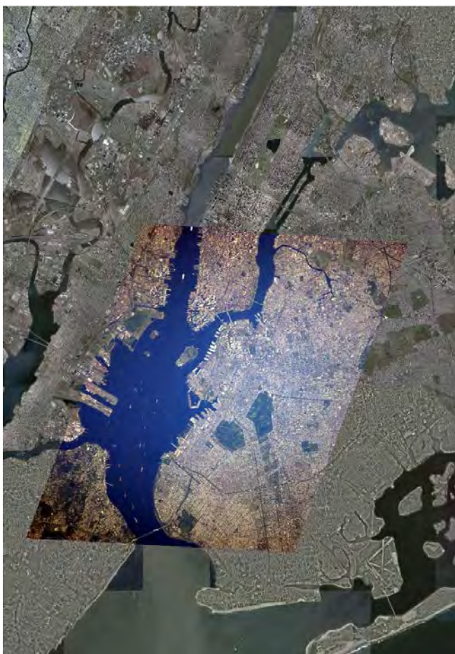
Рис. 3. Географически «привязанный» снимок, наложенный на ортофотоплан
