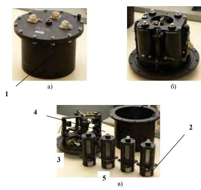
Рис. 1. Внешний вид экспериментального блока в сборе (а), после демонтажа защитного корпуса (б) и после демонтажа экспериментальных капсул (в)
