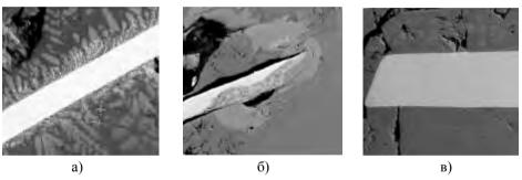
Рис. 11. Микроструктура образца Ni-Al с фольгами: а) тантал; б) ниобий; в) молибден
