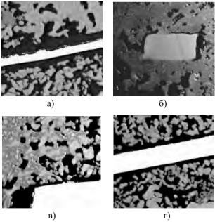
Рис. 8. Микроструктура образца Ti-Al с фольгами: а) ниобий; б) титан; в) молибден; г) тантал
