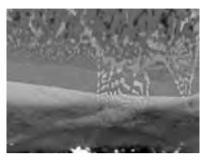
Рис. 17. Микроструктура внешнего слоя продукта СВС, полученного в условиях микрогравитации
