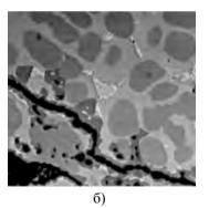
Рис. 6. Микроструктура образцов № 1 (а) и № 2 (б), синтезированных в условиях микрогравитации
