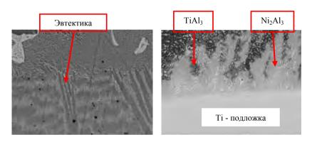
Рис. 16. Микроструктура поверхностного слоя титановой подложки (слева) и продукта СВС на поверхности подложки (справа), полученных в условиях микрогравитации
