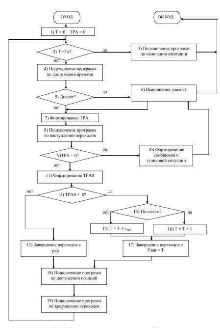
Рис.1. Блок-схема алгоритма имитации И-сети
