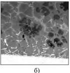
Рис. 9. Микроструктура образца Тi-Ni с фольгами: а) молибден; б) тантал
