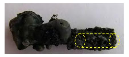
Рис. 14. Титановая подложка, покрытая продуктом СВС, полученным в условиях микрогравитации
