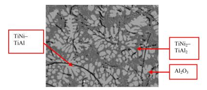
Рис. 15. Микроструктура продукта СВС, состоящего из сплава интерметаллидов на основе  $Ni_2Al_3$  (светлая фаза),  $TiAl_3$  (серая фаза) и оксида алюминия (темная фаза)
