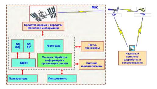
Рис. 41. Структурная схема многофункциональной информационной системы поддержки деятельности экипажа и принятия решений
