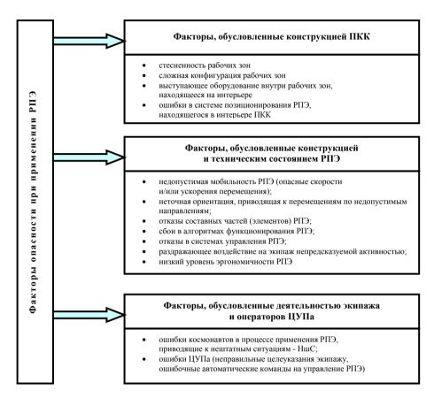
Рис. 5. Контролируемые факторы риска при использовании РПЭ на ПКА (для варианта ВнуКД)
