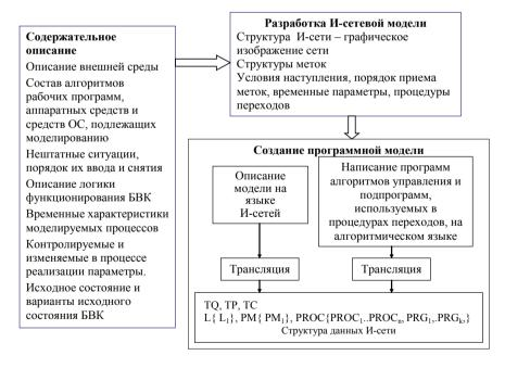
Рис. 2. Технология создания И-сетевой модели БВК
