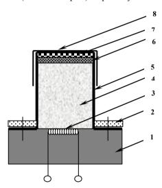
Рис. 4. Схема проведения экспериментов синтеза пористых функционально-градиентных материалов в космосе
