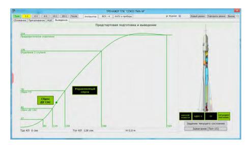
Рис. 9. Формат предстартовой подготовки и выведения ТПК на орбиту
