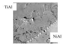
Рис. 10. Микроструктура реакционного соединения двух образцов
