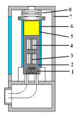
Рис. 12. Схема эксперимента по изучению взаимодействия расплавленного продукта СВС с металлическими подложками в невесомости: 1) поджигающая спираль; 2) реакционная смесь; 3, 4) металлические подложки (титан, дюраль); 5) теплоизолятор (SiO<sub>2</sub>); 6) кварцевая трубка; 7) корпус камеры; 8) стальная пружина, фиксирующая кварцевую трубку в
