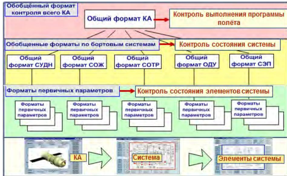
Рис. 21. Иерархическая структура форматов отображения ТМИ
