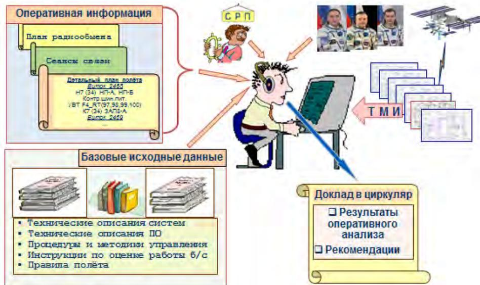
Рис. 24. Общая технология проведения оперативного контроля работы бортовых систем
