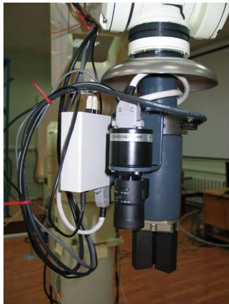
Рис. 4. Рабочий орган ПР в составе ФМС: видеочамера СТЗ, СМД, захватное устройство
