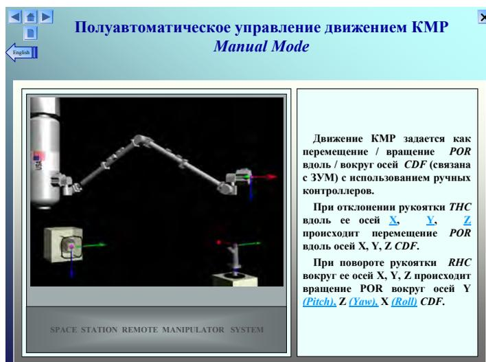
Рис. 13. Иллюстрация режима полуавтоматического управления от задающих рукояток
