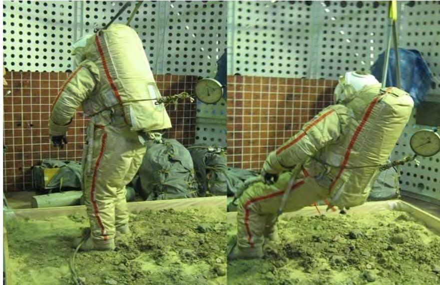
Рис. 4. Имитация ветровой нагрузки
