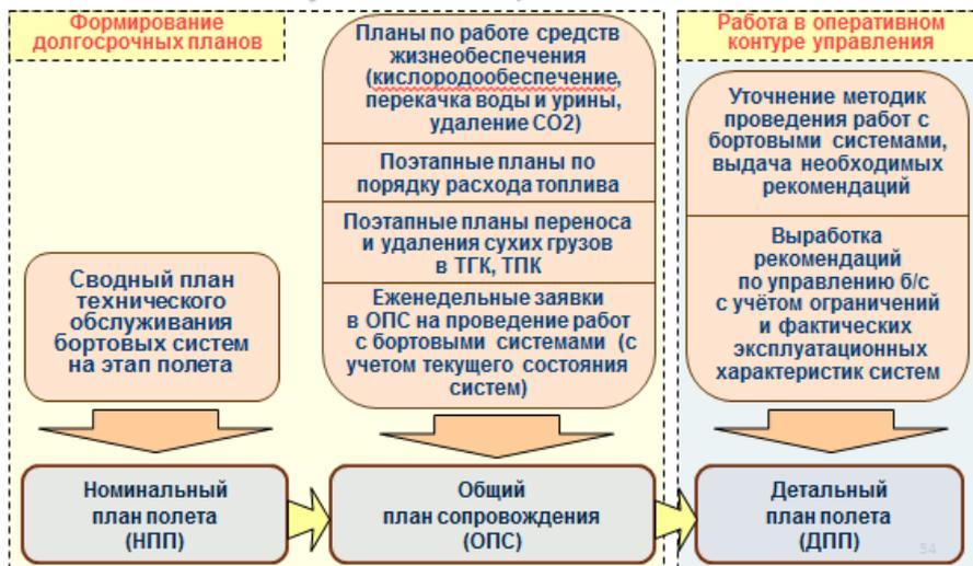
Рис. 22. Этапы планирования работ по летной эксплуатации бортовых систем
