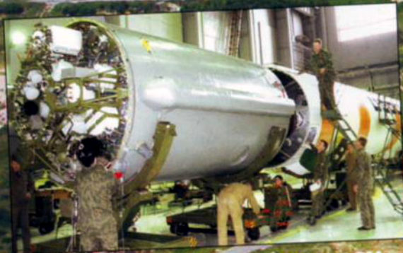
Сборка ракеты-носителя «Космос-3М» в МИКе космодрома Плесецк
