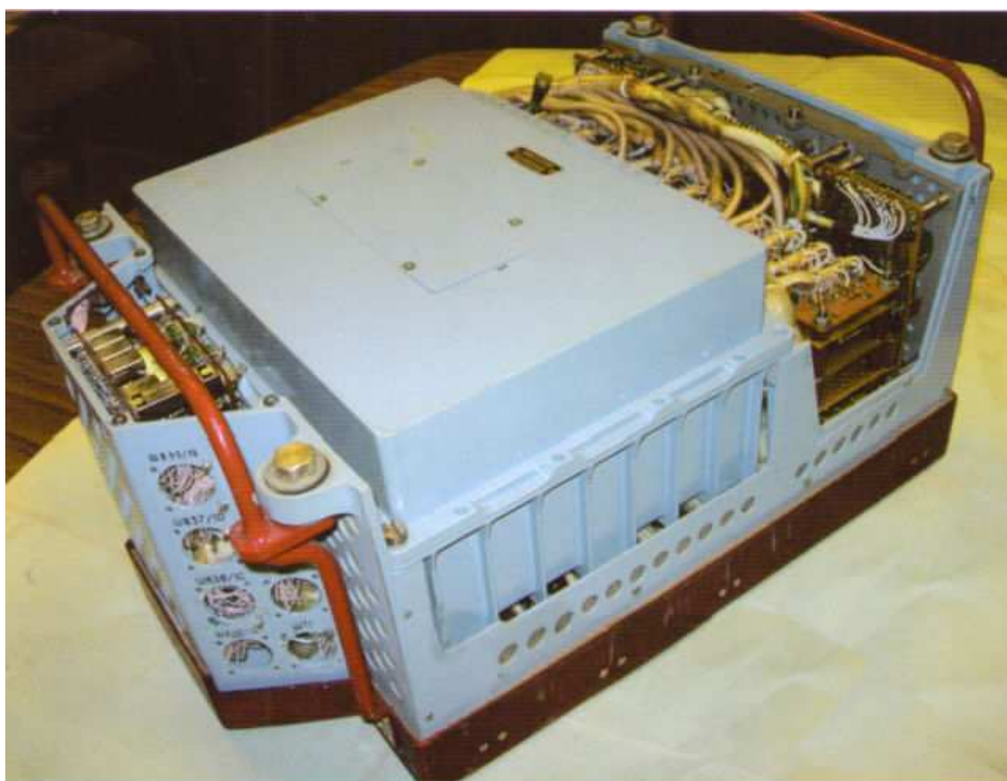
Пульт «Свет». Вид со стороны герметического блока электроники
