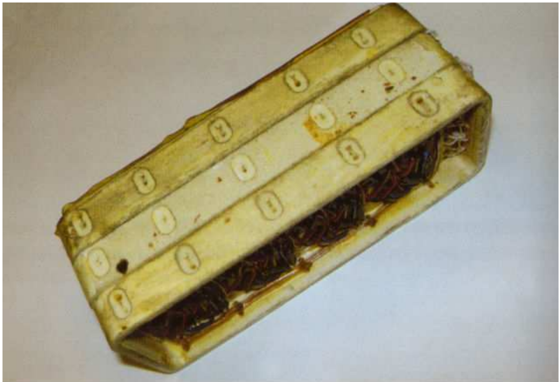
Сборка плат электроники приборов ПВУ и макета БЦВМ «Кобра» в блок («коробочку»)
