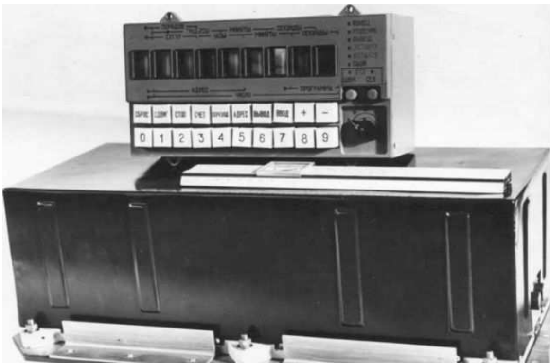
БЦВМ «Салют-1» с пультом управления, разработанные для лунного корабля Л1
