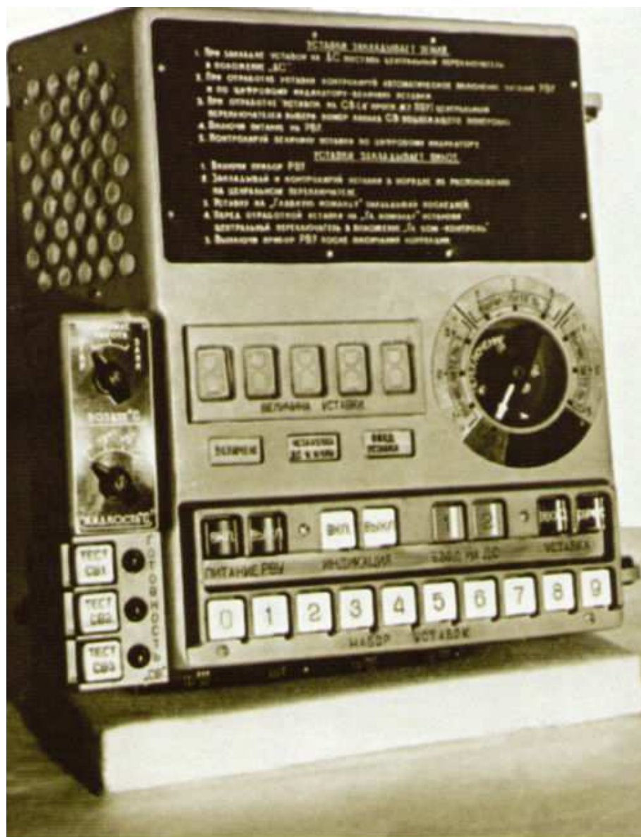
Прибор ручного ввода уставок в БЦВМ «Аргон-11С» корабля Л1
