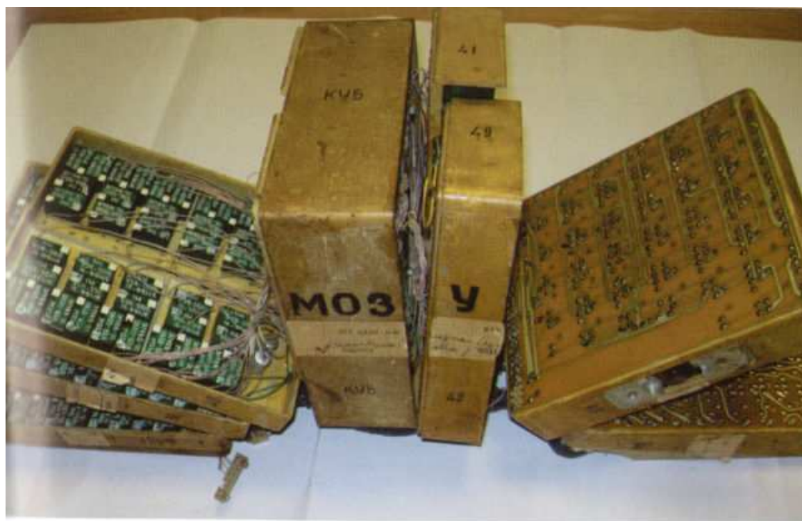
Оперативная память БСВМ «Вычислитель». Технологический образец Уфимского завода
