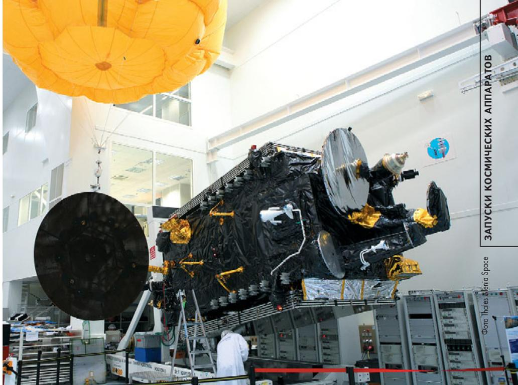
▲ Тест раскрытия антенн КА *Chinasat-9* на заводе Thales Alenia Space в Канне
