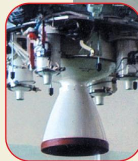
▲ Космический аппарат «Фотон» с твердотопливной тормозной двигательной установкой ППД 11D82M
