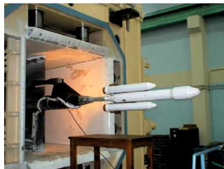
▼ Аэродинамические испытания модели ракеты GSLV Mk III. Носитель будет использоваться в пилотируемой программе Индии
