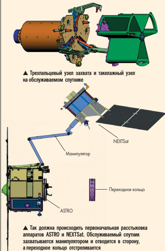
▲ Трехпальцевый узел захвата и такелажный узел на обслуживаемом спутнике
