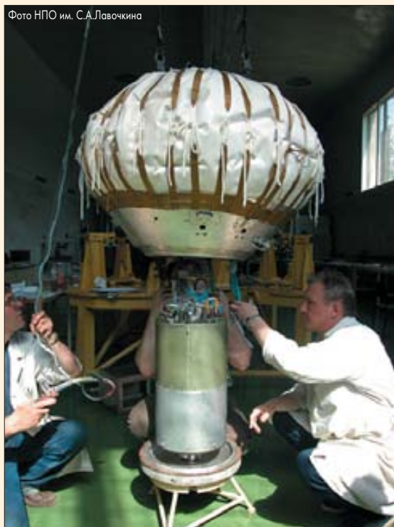
Монтаж «Демонстратора D-2R». Соединение ПТУ с приборным контейнером
