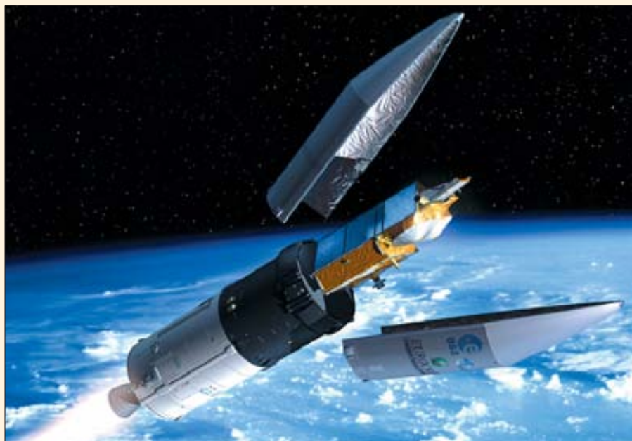
Сброс головного обтекателя РН «Рокот». Именно в такой конфигурации (со 2-й ступенью) Cryosat упал в океан
