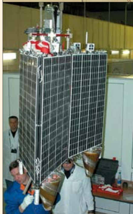
Иранский КА Sinah-1 изготовлен на базе платформы «Стерх». Фотографии дают представление о форме спутника и конструкции СБ
