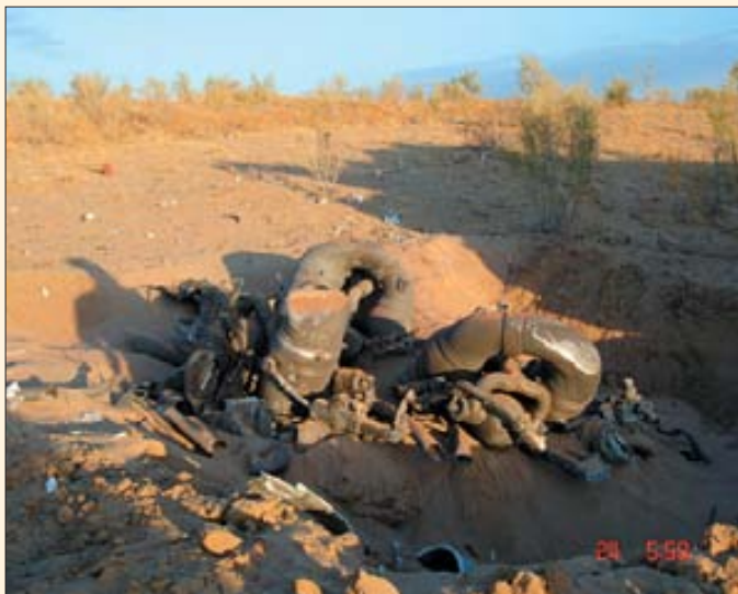
Двигательная установка первой ступени РН «Днепр» и фрагмент самой ступени на месте падения
