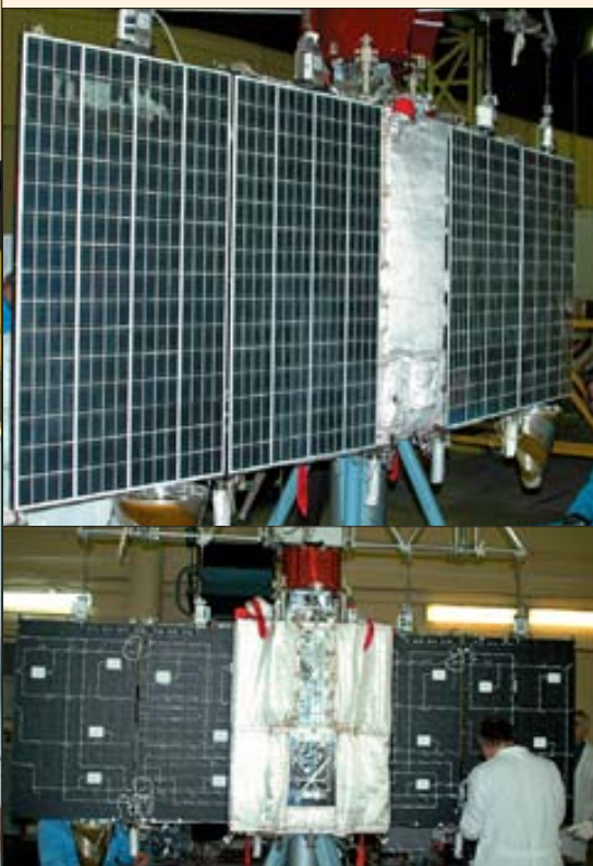
Иранский КА Sinah-1 изготовлен на базе платформы «Стерх». Фотографии дают представление о форме спутника и конструкции СБ
