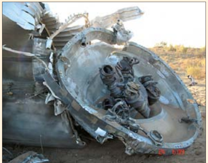
Двигательная установка первой ступени РН «Днепр» и фрагмент самой ступени на месте падения
