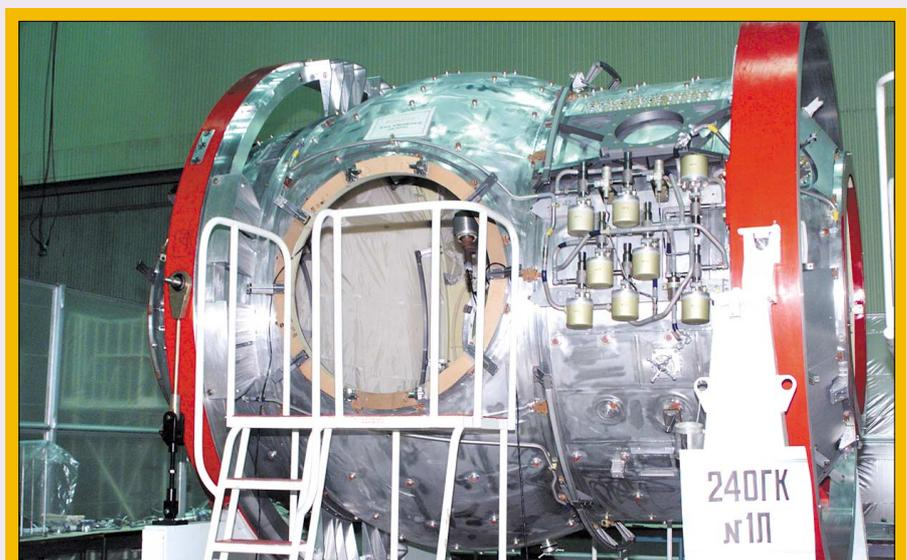
В РКК «Энергия» проходит сборка еще одного элемента российского сегмента МКС – стыковочного отсека
