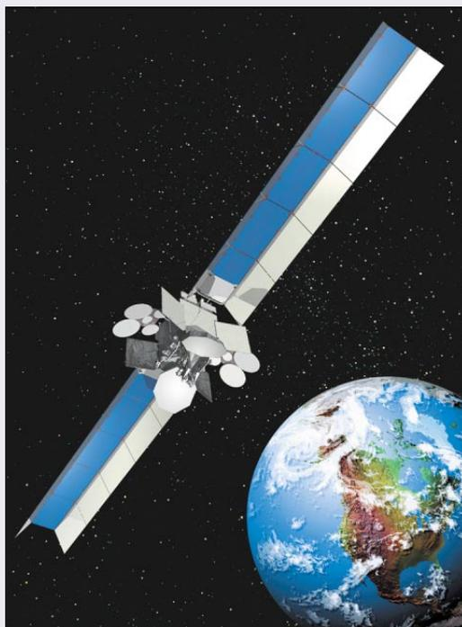
пакуют свой ресурс). Для этого спутнику требуется 14 кВт энергии, которую обеспечат две панели солнечных батарей с фотоэлементами на основе высокоэффективного арсенида галлия.
