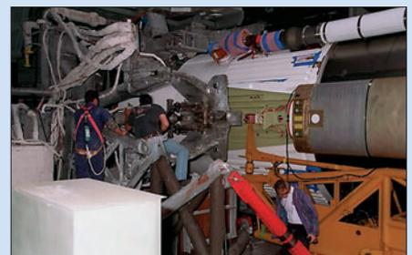
Установка креплений в хвостовой части ракеты Atlas 3
