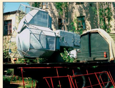
Станция, оснащенная антенной системой «Жемчуг» для непосредственного приема телеметрии с борта ракеты-носителя
