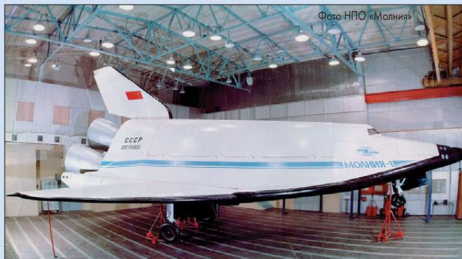
Макет одного из вариантов орбитального самолета МАКС в цеху НПО «Молния»
