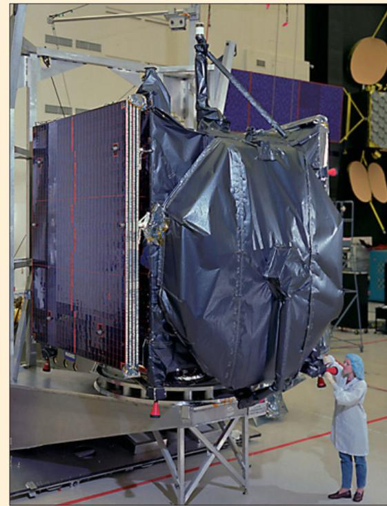
Подготовка КА JCSAT-6 на заводе-изготовителе (Hughes)
