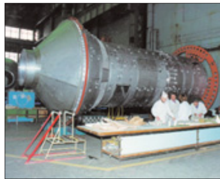
Изготовление корпуса тренажера ФГБ (видна боковая дверь для прохода внутрь тренажера).
