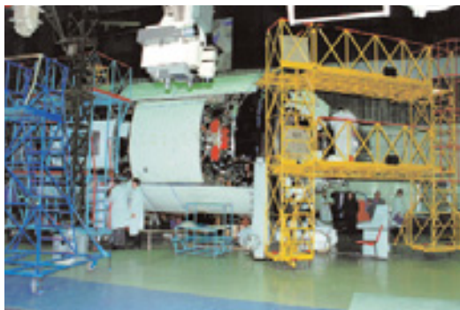
Энергетический блок ФГБ.
