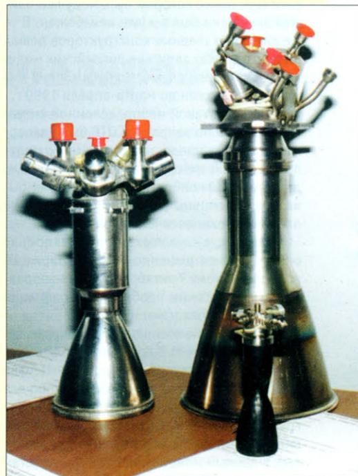
Использование новых материалов (углерода). ЖРД черного цвета рассчитан на высокое давление в камере, по тяге сравним с другими, имеющими большие габариты. Разница в размерах впечатляющая.
