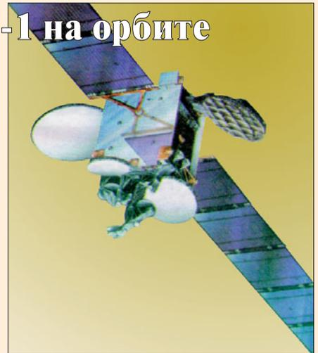
блока Eurostar 2000+. Стартовая масса КА – 3255 кг, масса на орбите – 1753 кг. Аппарат оснащен 14 ретрансляторами диапазона С и 18 ретрансляторами диапазона Ku и имеет мощность СЭП – 8.3 кВт.
